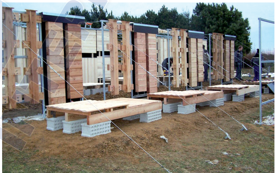
Les ouvrages exposés sur les sites expérimentaux correspondent à des cas classiques d'utilisation du bois en extérieur : platelages, bardages, bois empilés, poteaux... Ici le site de Charrey-sur-Saône.
